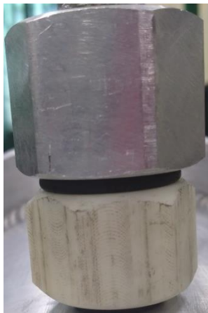
Fig. 2.8 Guardas de acrílico para conexiones de alto voltaje.
