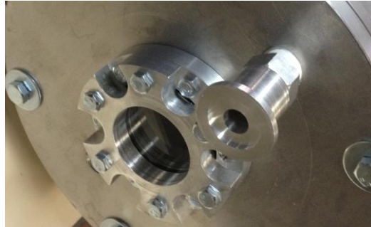
Fig. 2.2 Montaje de ventana y conexión ISO para abrazadera tipo clamp.
